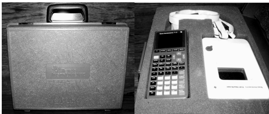
Рис. 1. Система для преподавания математики LTA90 (Texas Instruments, США) помещается в небольшом чемодане (слева) и состоит из хэндхелда TI-81, рамки ViewScreen и соединительного кабеля (справа)
