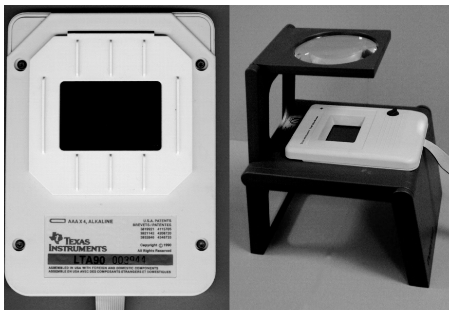
Рис. 2. Рамка ViewScreen (слева) может устанавливаться на поляроидный увеличитель (справа)
