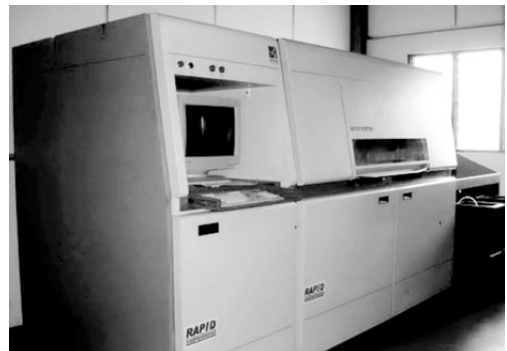
Рис. 6. 3D-принтер, использующий SLS-технологию — устройство компании RapidForm
