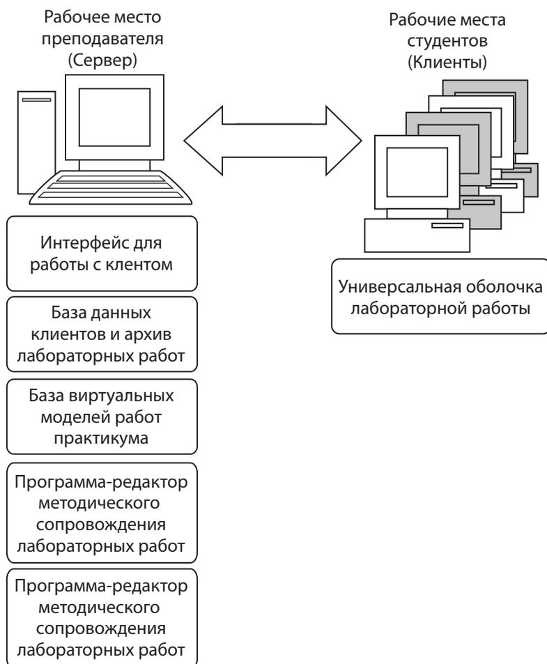
Рис. 1. Структура виртуальной лаборатории
