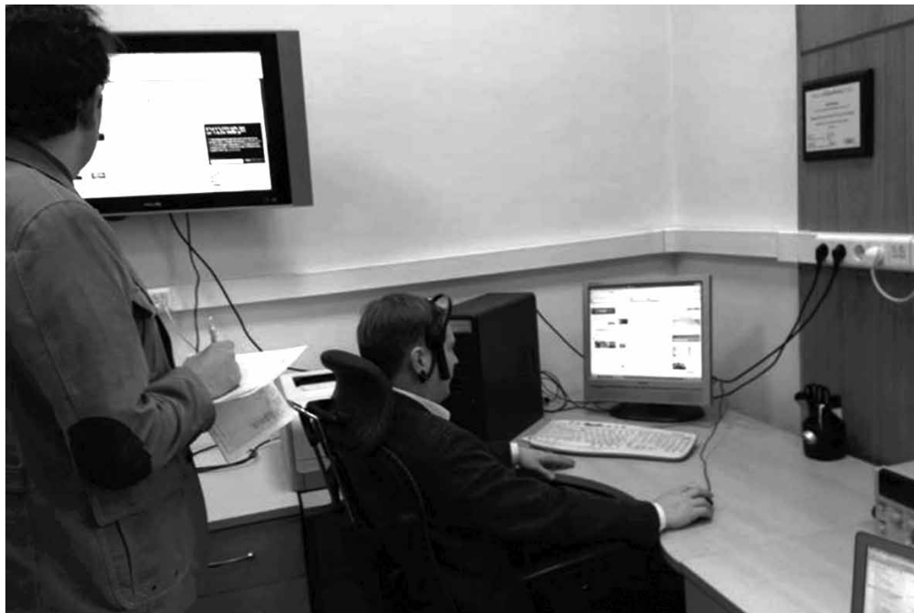
Рис. 4. Проведение юзабилити-тестирования с использованием NeuroSky MindWave
