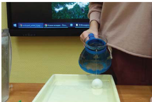
Рис. 14а, б. Движение шарика вбок и вперёд под действием струи, которая его обтекает сверху
