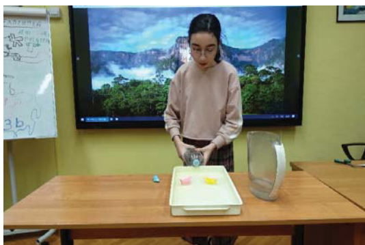
Рис. 13а, б. Кораблики сближаются из-за снижения давления в струе воды, запущенной между ними из бутылки
