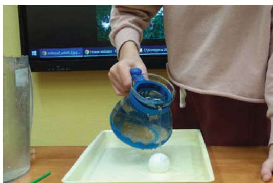
Рис. 14 в, г. Движение шарика вперед и вбок под действием обтекающей его струи
