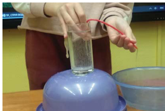
Рис. 15а, б. Набираем в трубку воду и зажимаем конец. Опускаем зажатый конец ниже уровня воды в стакане
