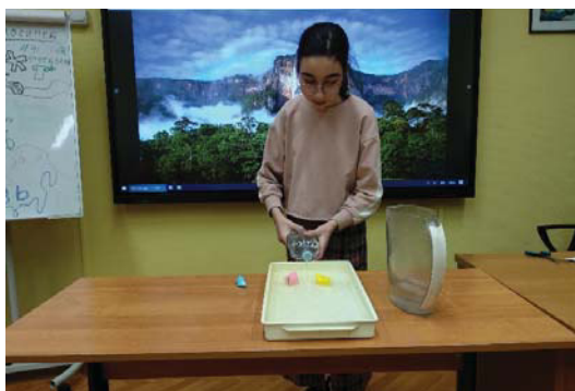
Рис. 13а, б. Кораблики сближаются из-за снижения давления в струе воды, запущенной между ними из бутылки
