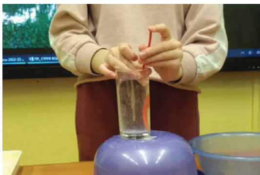
Рис. 15а, б. Набираем в трубку воду и зажимаем конец. Опускаем зажатый конец ниже уровня воды в стакане
