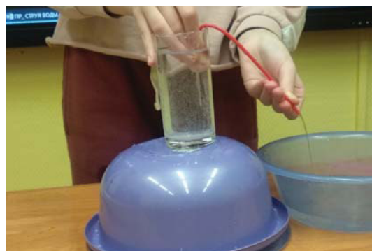
Рис. 15в, г. Вода выливается из трубки, потом начинает подсасывать воду в стакане и литься ровной струёй
