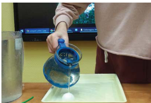
Рис. 14 в, г. Движение шарика вперед и вбок под действием обтекающей его струи
