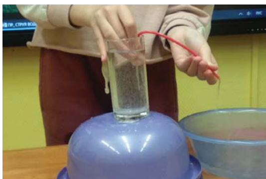
Рис. 15в, г. Вода выливается из трубки, потом начинает подсасывать воду в стакане и литься ровной струёй
