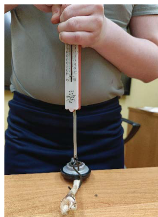
Рис. 15. Цела при усилии 10 кг
