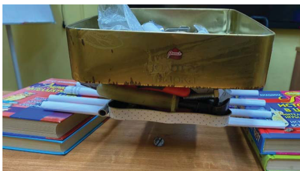
Рис. 10. Испытание на изгиб длинных трубочек
