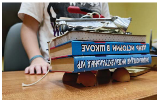
Рис. 20. Накладываем груз на книги, установленные на 4 купола из яичной скорлупы
