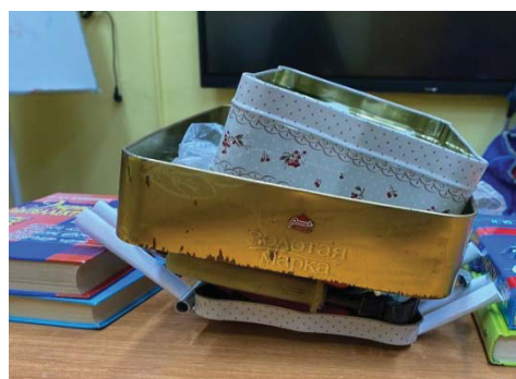
Рис. 11. Мостик из длинных трубочек сломался при весе 4,8 кг
