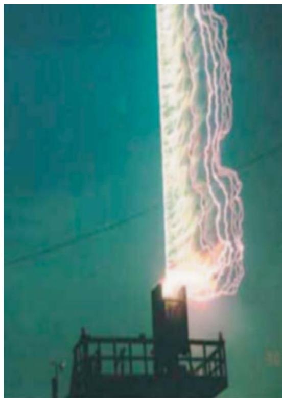
Рис. 1. В 1990-х годах исследователи научились вызывать молнии, не подвергая опасности свою жизнь. Один из способов вызвать молнию — запустить с земли небольшую ракету прямо в грозовую тучу. Вдоль всей траектории ракета ионизирует воздух и создает, таким образом, проводящий канал между тучей и землей. И если отрицательный заряд низа тучи достаточно велик, то вдоль созданного канала происходит разряд молнии, все параметры которого регистрируют приборы, расположенные рядом со стартовой площадкой ракеты. Чтобы создать еще лучшие условия для разряда молнии, к ракете присоединяют металлический провод, соединяющий ее с землей.
