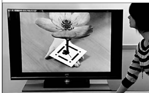
Рис. 5. Аппаратное обеспечение экспоната «Зелёная машина времени» распознаёт с помощью камеры демонстрируемую метку и выводит на экран соответствующее изображение, которое может сопровождаться звуком
