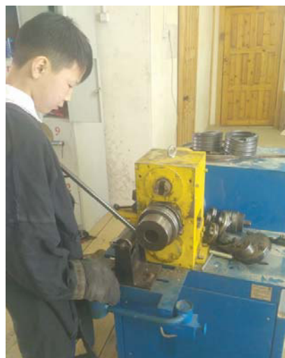
Фото 2. Кузнечный станок «Ажур-1М»
