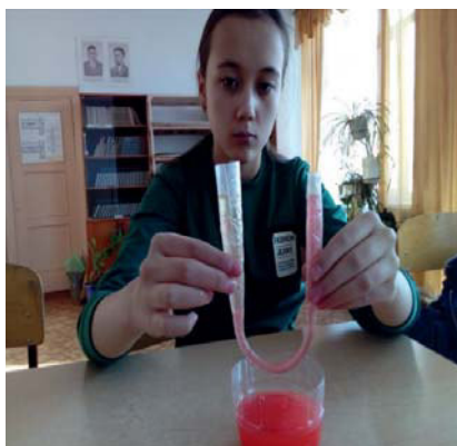
Рис. 14. Сообщающиеся сосуды неоднородная жидкость № 2
