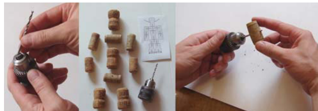
Рис. 5. Выполнение отверстий в пробковых деталях
