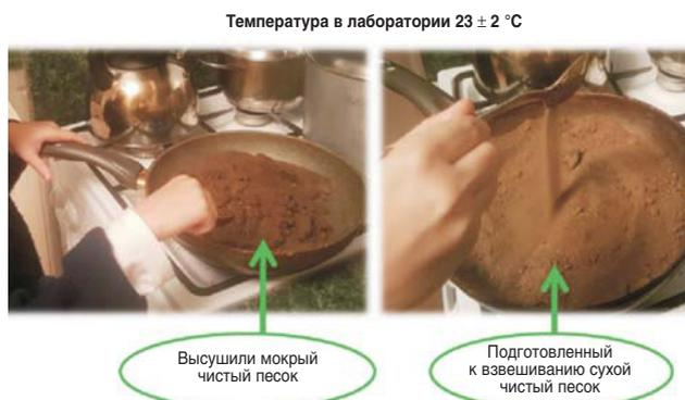
**Рис. 3. Высушивание чистого экспериментального песка**
