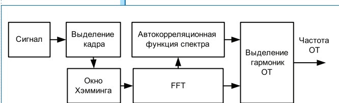
Рис. 5. Структурная схема метода оценки частоты основного тона речи с использованием автокорреляционной функции спектра
