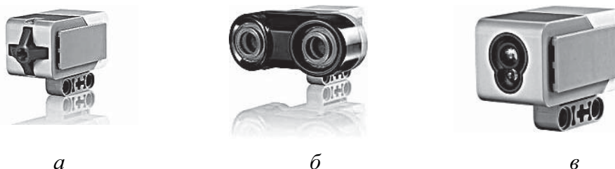
Рис. 5. Датчики роботов Lego: а — датчик касания; б — датчик расстояния; в — датчик цвета/света/освещённости
