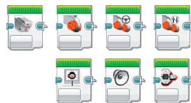
Блоки действий управляют действиями в рамках программы. Они контролируют вращение моторов, а также изображения, звук и подсветку модуля EV3.
