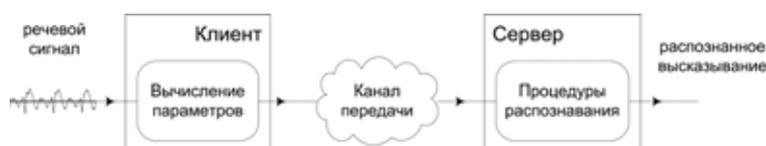
Рис. 5. Распределённая система распознавания речи
