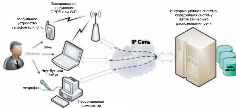
Рис. 1. Использование удалённой системы распознавания речи
