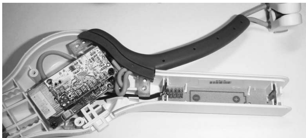
Рис. 2. Нейроинтерфейс. В составе: чип для ЭКГ, чип Blue Tooth, контакт для лба, референс контакт для мочки уха
