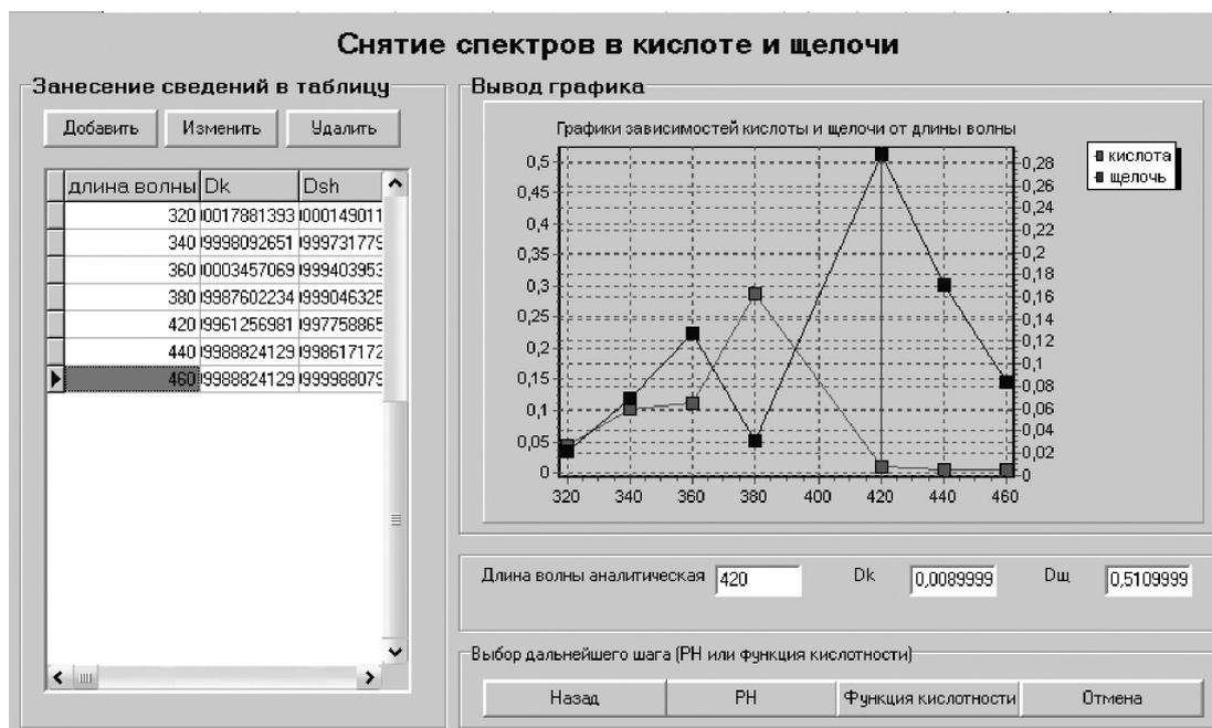
Рисунок 9. Снятие спектров поглощения веществ. Одна из форм авторского виртуального лабораторного стенда
