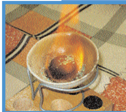
Желтоватое пламя от крупинки поваренной соли — анализ на присутствие натрия
