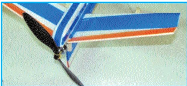
В местах стыковки фюзеляжа со стабилизатором и килем делаются пропилы шириной 3 мм и под определенным углом в пропиленные детали вклеиваются.
