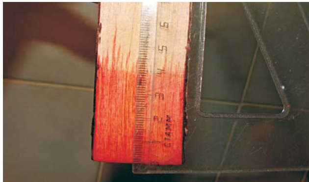
Рис. 20. Измерение глубины впитываемости
