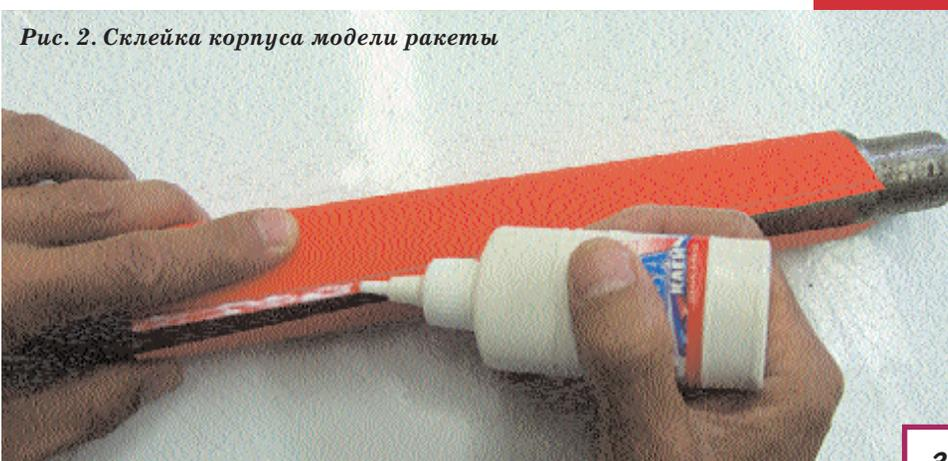
*Рис. 2. Склейка корпуса модели ракеты*
