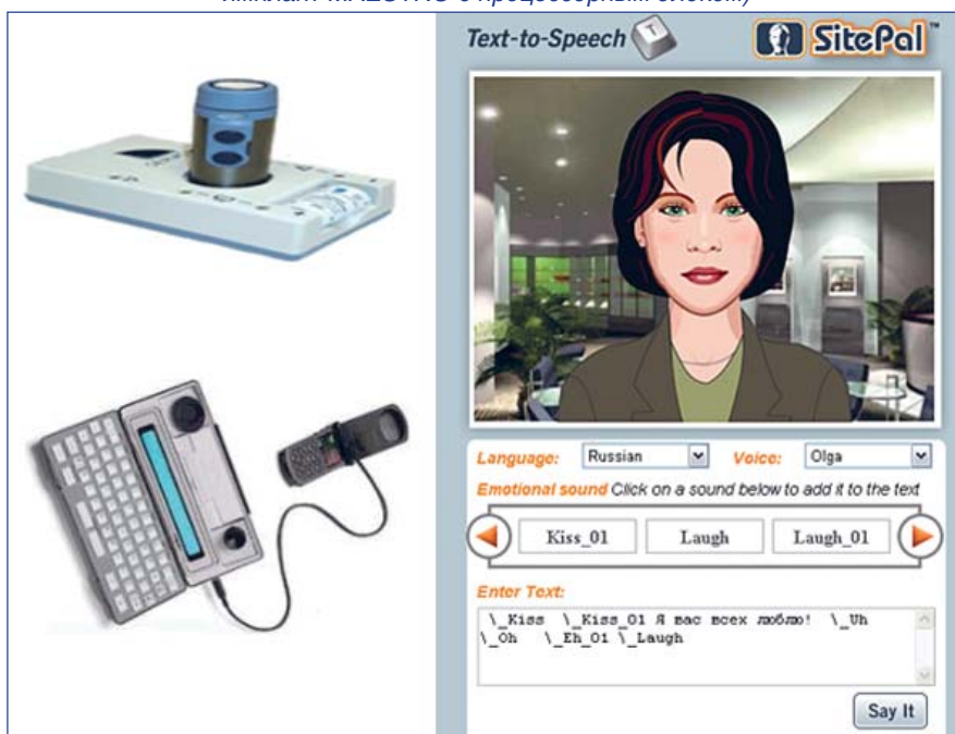
Рис. 4. Ассистивные устройства для лиц с нарушениями речи (голосовозражающий аппарат для гортани Servox Digital; телетайпное устройство для телефона Compact/C; синтезатор аудиовизуальной речи SitePal).
