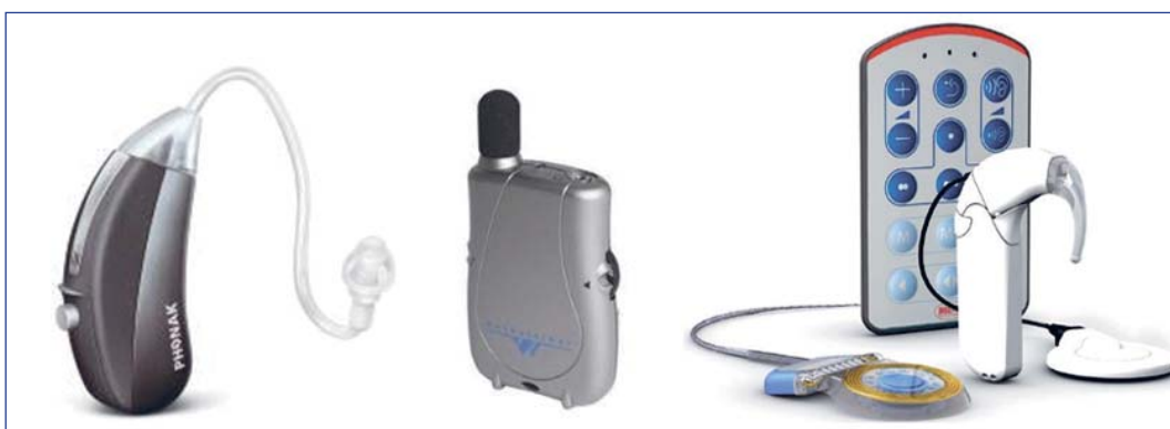
Рис. 3. Ассистивные устройства для лиц с нарушениями слуха (слуховой аппарат PHONAK; противошумный усилитель Rocketalker Ultra; кохлеарный имплант MAESTRO с процессорным блоком)
