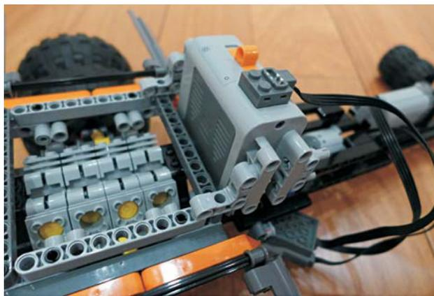
13. Крепим второй мотор для поворота колес.
