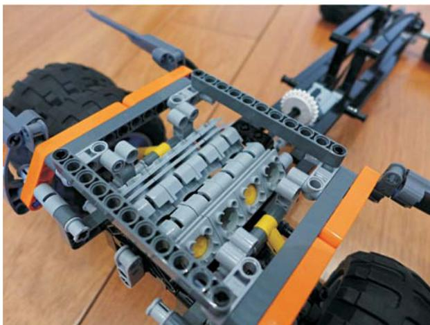
10. Совмещаем шестеренки, для того чтобы при вращении мотора вращались не только задние колеса, но и элементы двигателя.
