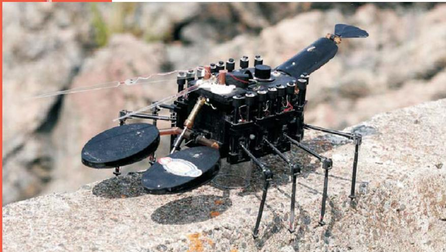
*Подводный робот-спасатель «RoboLobsrer», разработанный профессором Джозефом Айресом (штат Массачусетс), предназначен для прогулок по морскому дну в поисках подводных мин, которые не только находит, но и уничтожает*
