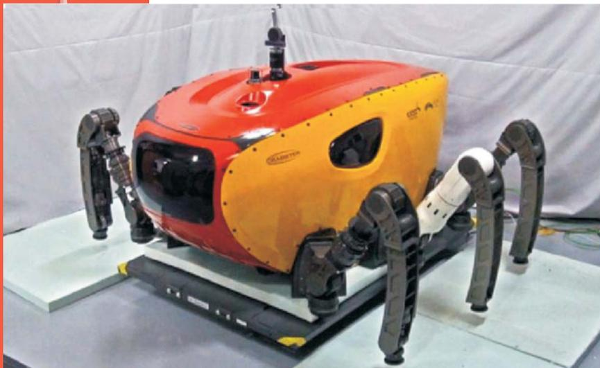
*В Корейском институте изучения океана работают над проектом оригинального исследовательского аппарата. Он передвигается по дну на шести конечностях, может делать детальные фотографии, составлять карты посредством сонара (ультразвукового аппарата), собирать образцы в специальный отсек, а также проводить подъемные и монтажные операции с помощью манипуляторов*
