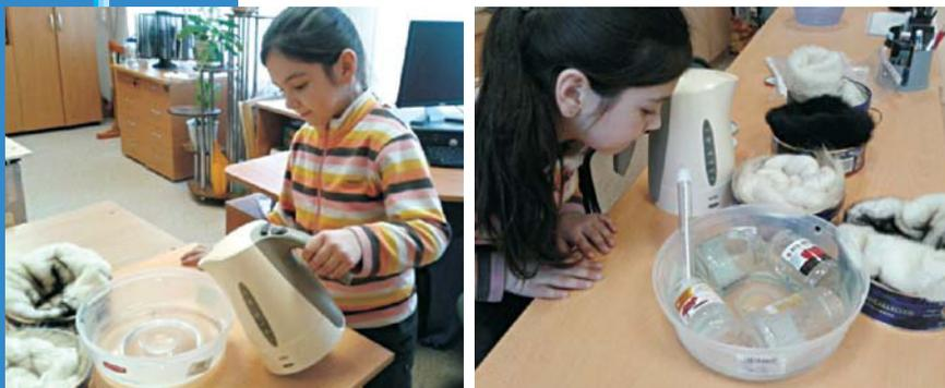
В каждую банку налила воды из чайника и укутала каждую коробку мехами разных животных. А потом каждые полчаса измеряла температуру воды. Все результаты записала в таблицу. Вот что получилось:
