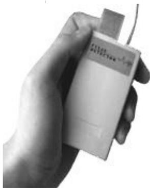
**Рис. 1.** Прибор «Детектор пульса» регистрирует пульс и передаёт его в компьютер в качестве управляющего параметра игры
