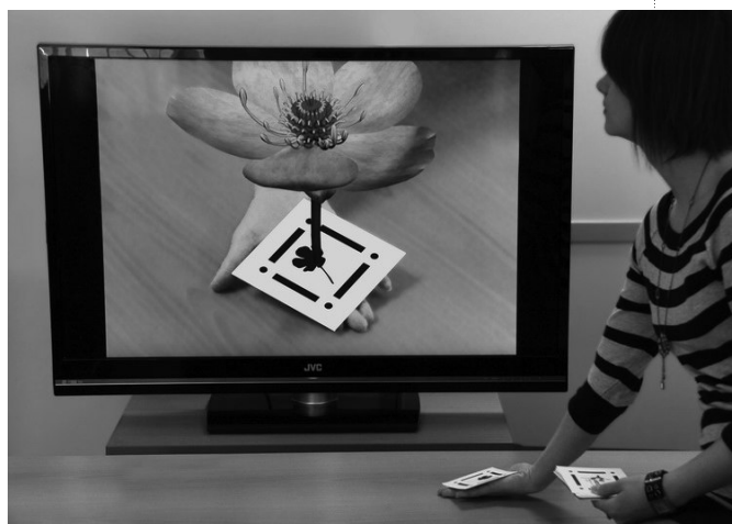
Фото 5. Аппаратное обеспечение экспоната «Зелёная машина времени» распознаёт с помощью камеры демонстрируемую метку и выводит на экран соответствующее изображение, которое может сопровождаться звуком
