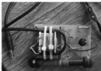
Рис. 13. Передающее устройство с амплитудной модуляцией средневолнового диапазона
