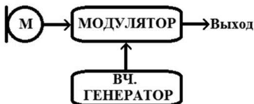
Рис. 5. Блок-схема процесса модуляции
