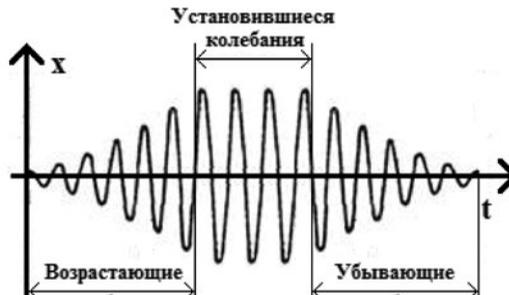
Рис. 8. Колебательный процесс
