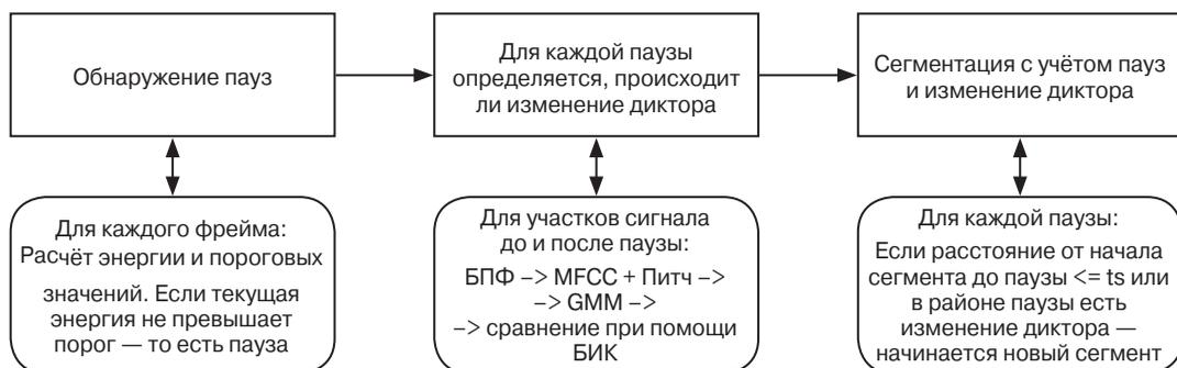
Рис. 4. Процесс сегментации сигнала
