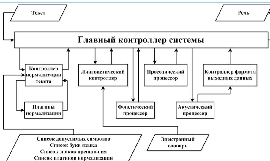
Рис. 2. Модульная структура синтезатора речи
