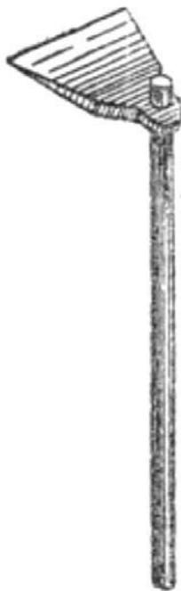
**Рис. 8. Железный гребок для перемешивания материала пробы**
