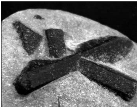
Рис. 7. Крестообразный двойник ставролита
