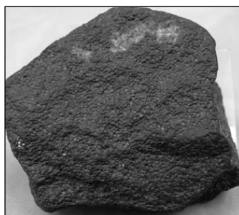
Рис. 13. Оолитовое строение гематита
