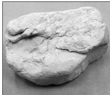
Рис. 32. Каолинит, землистый излом
